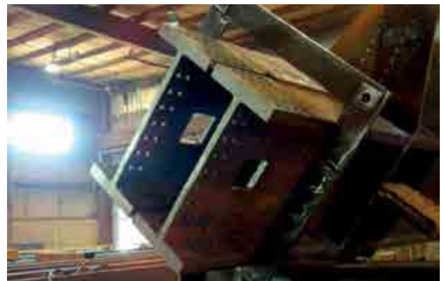
Deux profils soudés ensemble Two heavy sections welded together Zwei zusammengeschweißte Profile
