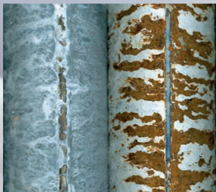
Magnelis® ZM120 сварной участок, без повторного покрытия
