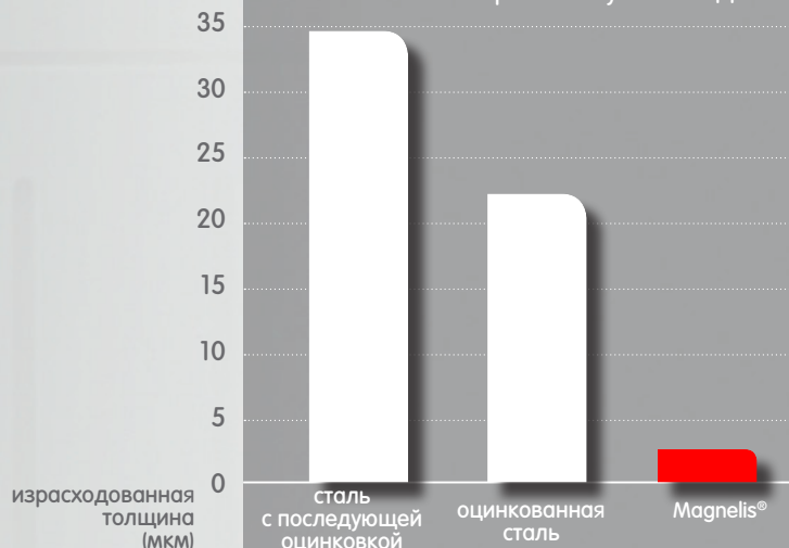
Продукт с горячей оцинковкой в 20 мкм спустя 6 недель
