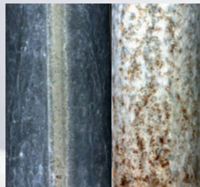
Magnelis® ZM310 сварной участок с повторной защитой
